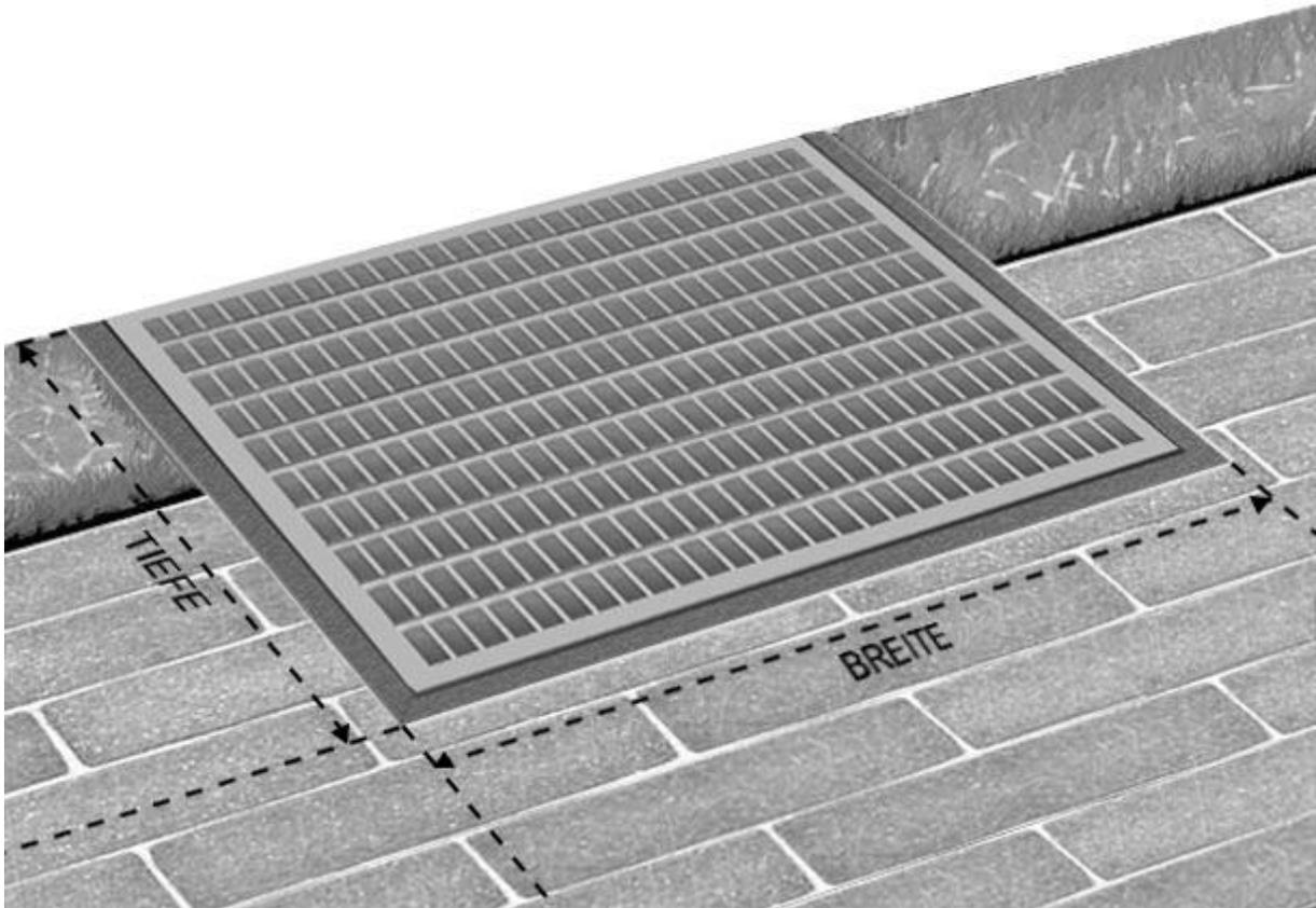
Wie abgebildet, müssen Sie die Aussenmasse des Betonrandes ausmessen damit dieser jeweils auch abgedeckt wird.
